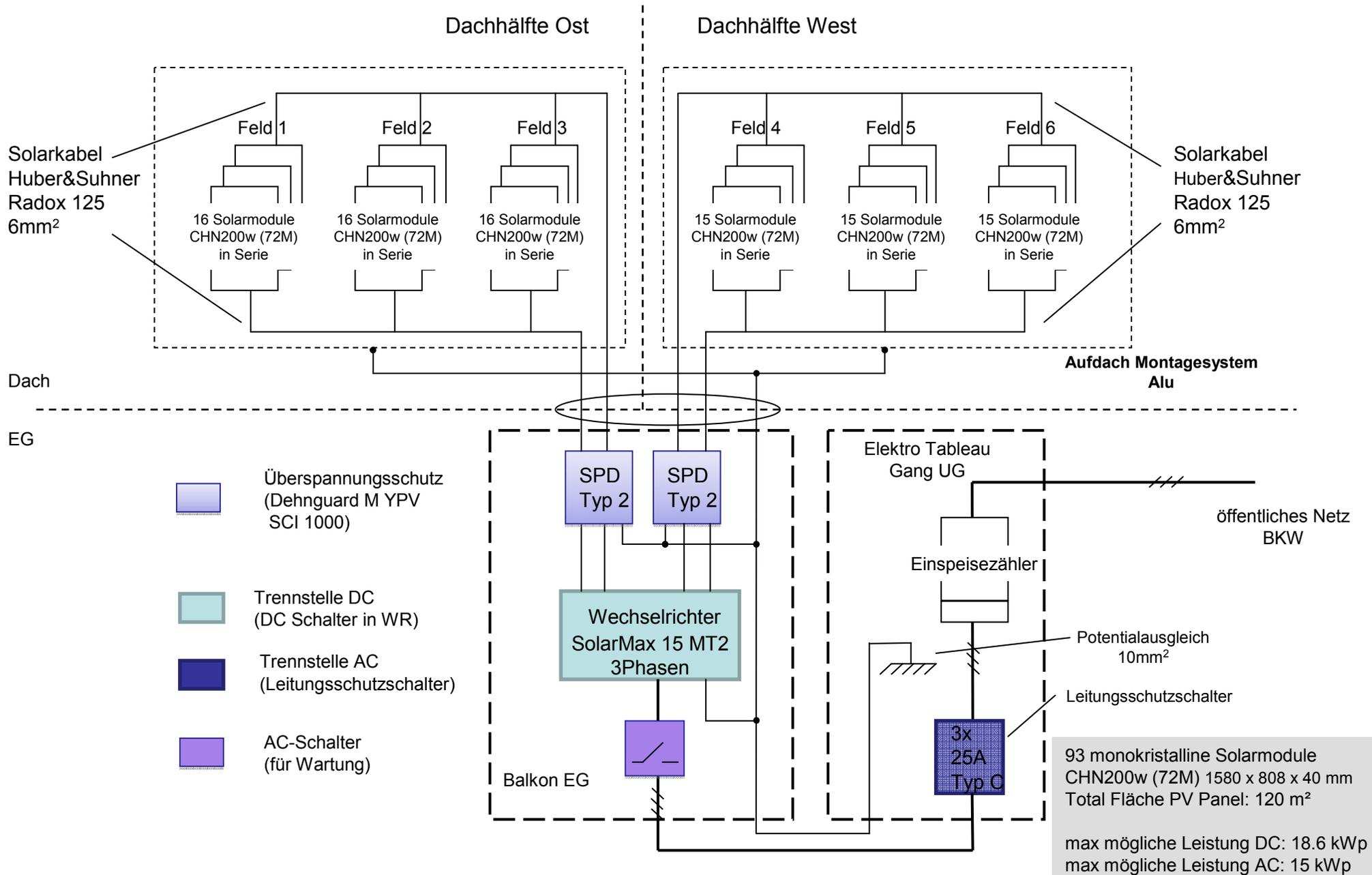
**Prinzipschema Photovoltaik Anlage
